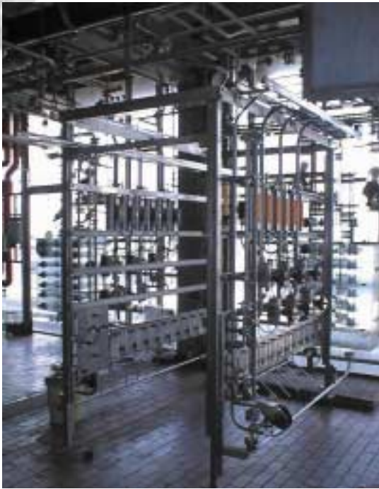
Abb. 14: Mini- und Mikroreaktoren in der chemischen Produktion: Anlage der Merck KGaA mit mikrostrukturierten Bausteinen
