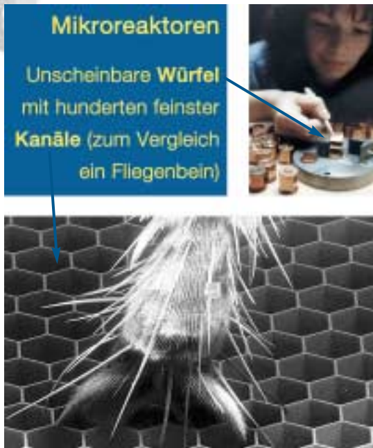
Abb. 9: Dimension und Aufbau von Mikroreaktoren (Hergestellt am Forschungszentrum Karlsruhe) [7]
